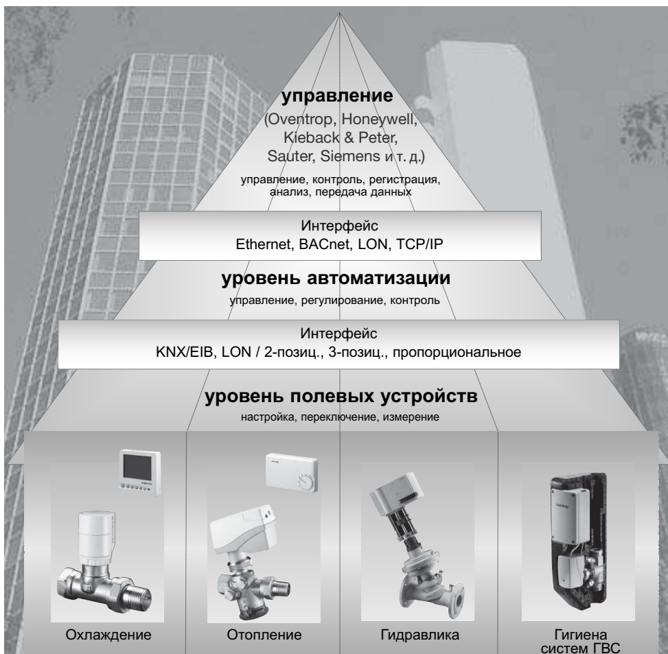
Обзор системы автоматизации здания и ее компонентов
